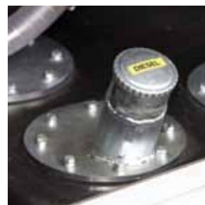
Бак для дизельного топлива PE объемом 180 л
